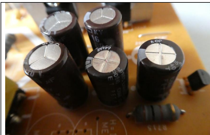
Zone des condensateurs électrochimiques
