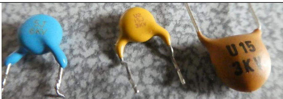
Exemple de condensateur de remplacement (valeur 15pF, 3 Kv)
