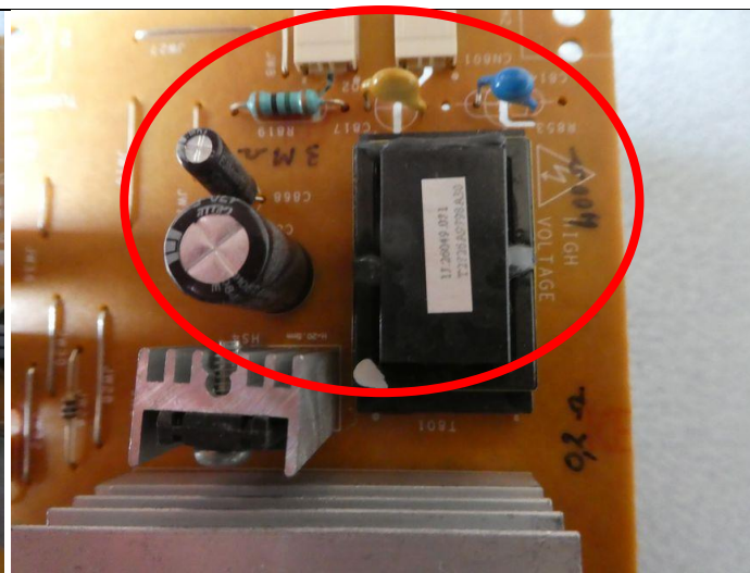
Zone haute tension droite
