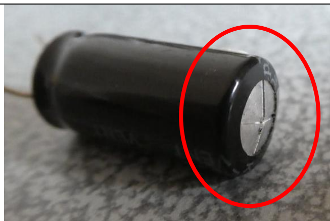
Exemple d'un condensateur défectueux (bombage)
